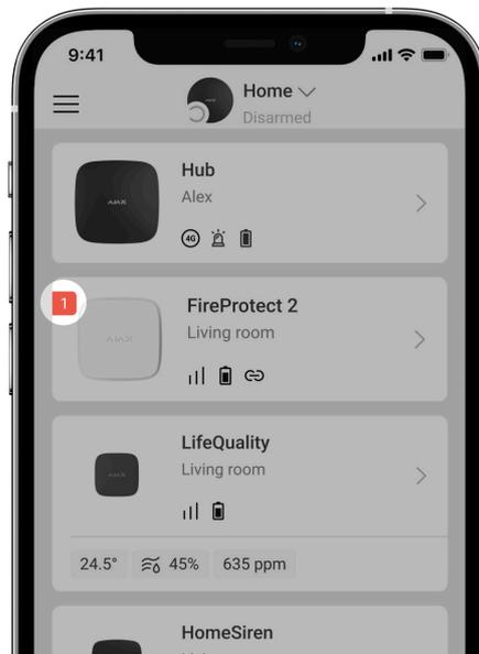
Wird eine Störung von FireProtect 2 festgestellt (z. B. keine Verbindung mit der Hub-Zentrale), wird ein Störungszähler im Feld des Geräts in den Ajax-Apps angezeigt.
